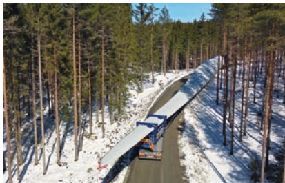
Transport eines Windradflügels: Der SCHEUERLE RBTS besteht aus zwei Transportmodulen, wobei das selbsttragende Rotorblatt als Verbindungselement dient.
